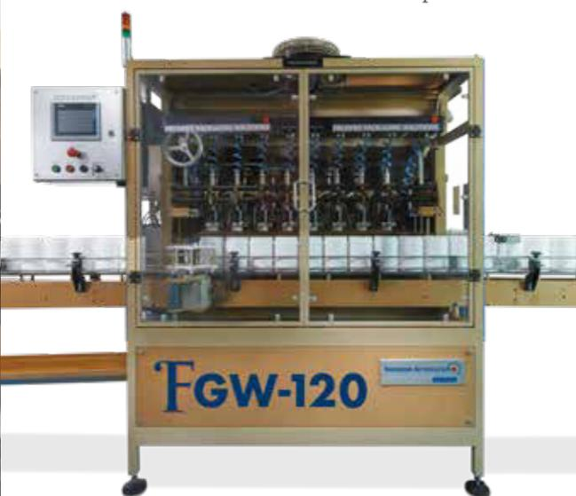
MÁQUINA DE ENCHIMENTO FGW-120 DA SHEMESH AUTOMATION COM COMPLETA EXPLOSÃO (EX) E PROTEÇÃO CONTRA CORROSÃO
