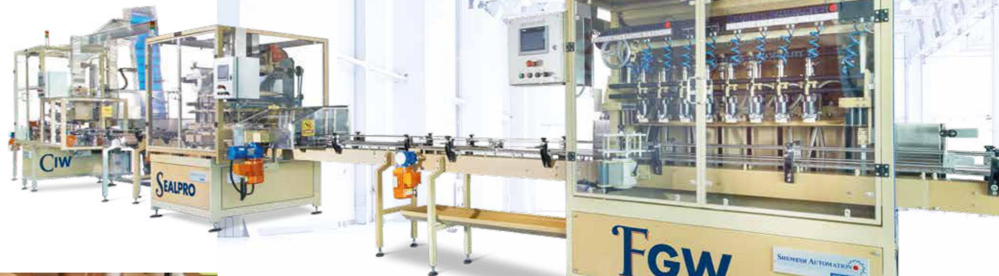
Linha Shemesh Automation Core Filling Sealing and Capping 120ppm com proteção completa contra explosão (EX) e corrosão.
