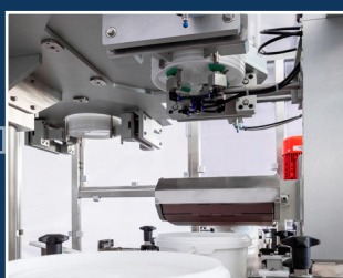
Fixador e transportador de tampas de balde
