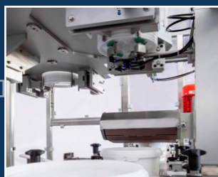
Fixador e transportador de tampas de balde
