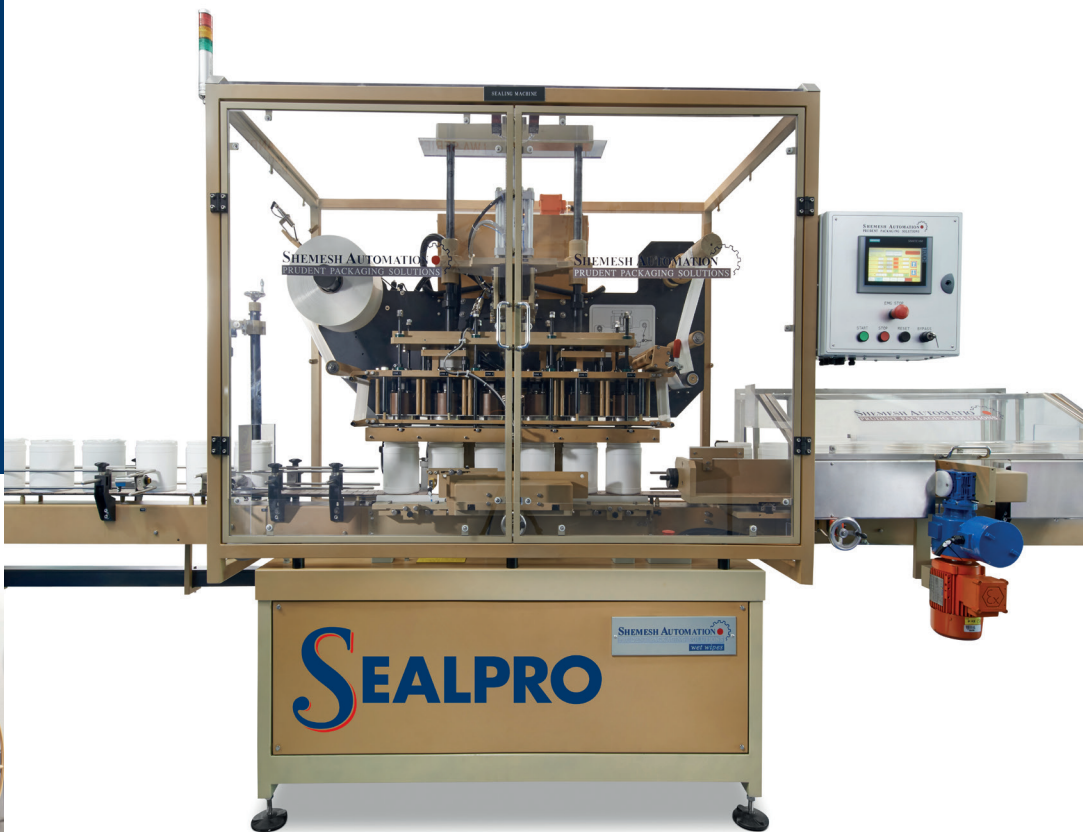
SEALPRO120 DA SHEMAH AUTOMATION'S SEALPRO120 TOTALMENTE AUTOMÁTICA DE CORTE DE LAMINADOS E MÁQUINA DE SELAGEM DE CONDUÇÃO COM EXPLOÇÃO COMPLETA (EX) E PROTEÇÃO CONTRA CORROSÃO
