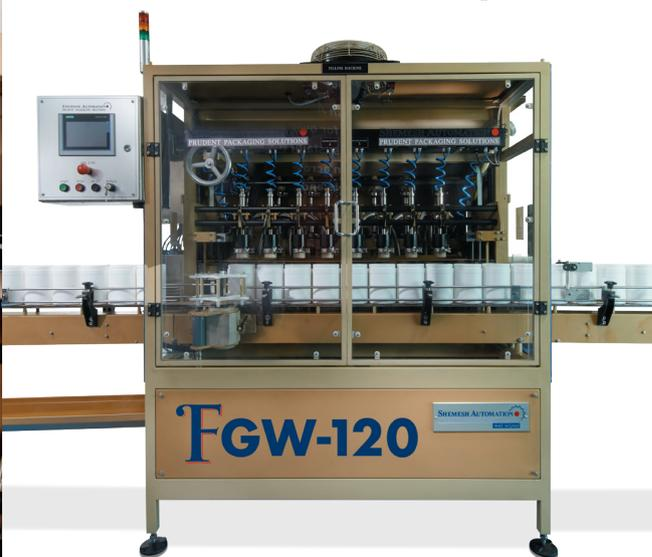
MÁQUINA DE ENCHIMENTO FGW-120 DA SHEMESH AUTOMATION COM COMPLETA EXPLOÇÃO (EX) E PROTEÇÃO CONTRA CORROÇÃO
